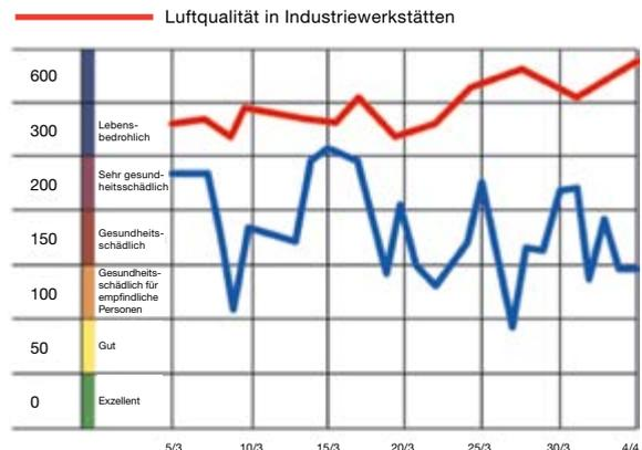
finden Sie die Werte einer gewöhnlichen Produktionsumgebung, in welcher das Schweißen von Edelstahl zu den Hauptaufgaben gehört. Zur Ermittlung der Hintergrundwerte der Arbeitsumgebung wurden Messungen durchgeführt. Die Grafik zeigt deutlich, dass die Luftqualität am Arbeitsplatz während eines Zeitraums von 30 Tagen um einiges schlechter war als die Luftqualität in Peking.
